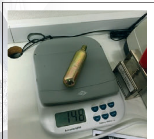
Gaspatronen er Godkendt/OK, der står 146,6 gram på den, men den viser 148 gram, så der er rigeligt med gas på, og den skal ikke skiftes.
